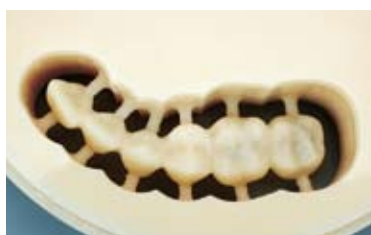
Aadva ミル LD-Iでの削り出し状態。
