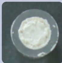
接着面には凝集破壊が観察され、ソフトポイントとシーラーの馴染みが良好であることがわかります。
