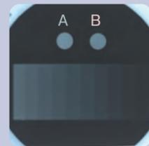
1mm厚円盤に成型したガターパーチャソフトポイントのX線造影性
