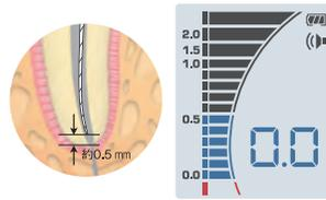
ファイル先端が根尖孔に達するとバーグラフは「0.0」を表示。アラート音が連続した音に変わります。
