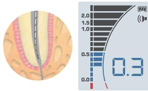
ファイル先端が根尖部付近に達するとバーグラフの色が青色に、同時にアラート音も変化することで、根尖孔に近づいていることをお知らせします。
