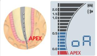
ファイル先端が根尖を越えた場合、赤いライン(APEX)の文字が表示されると同時に連続した速いアラート音でお知らせします。
