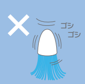
ゴシゴシ 強く擦るように動かさないでください。(適正圧:20~25g)
