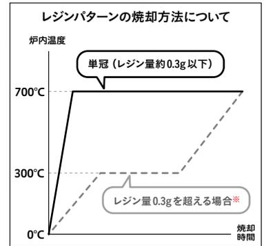
※大型のパターンの場合は300°Cで1時間係留後、炉内温度を上昇させてください。
