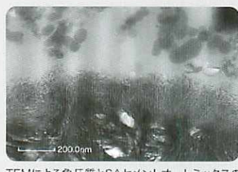
TEMによる象牙質とSAセメントオートミックスの接着界面写真 撮影：クラレメディカル(株)
