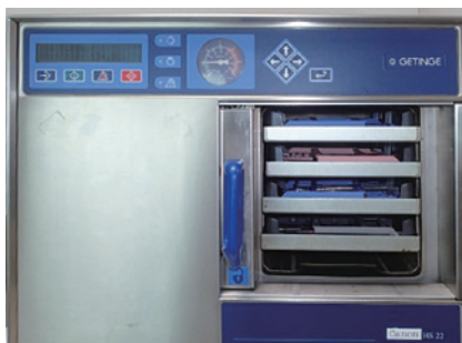
滅菌バッグに入れずにオートクレーブに入れた例
