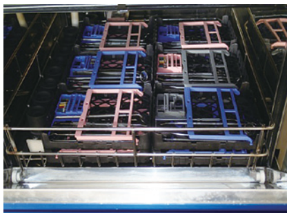
トレーが重なっていても内部の器具の重なりがなく洗浄可能
