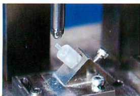
i-TFCポストとポストレジンからなる試験体の繰り返し衝撃試験
