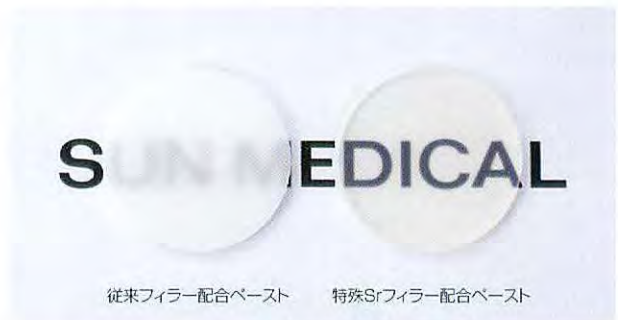
フィラーによる透明性の比較 (同一配合量)
