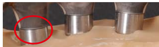
ディギッシングによるメタルフレームの歪み(当社従来品で焼成)
