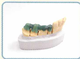
3Dプリンタにより造形された レジンパターン
