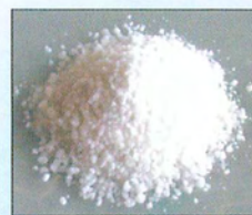
プレポリマー (ナノサイズフィラー) が高密度に 含有されている
