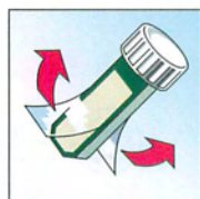
寒天培地に触れないよう に両面の防護紙を剥がす。
