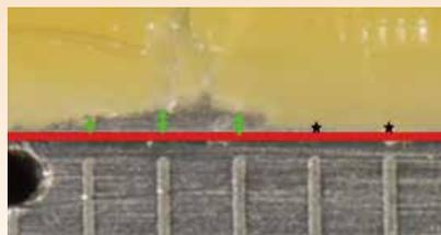
歯肉溝を模型で再現した実験です。赤線で示した歯肉溝の深いところまで印象材が流れているのがわかります。
