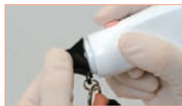
校正キャップをつけてキャリブレーション
