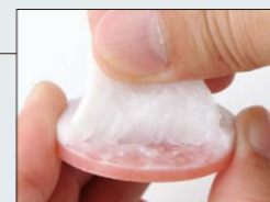
プライマー未使用
