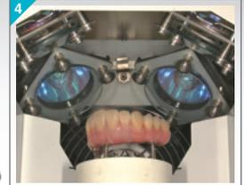
技工用光重合器を用いて、規定の時間光重合を行います。
