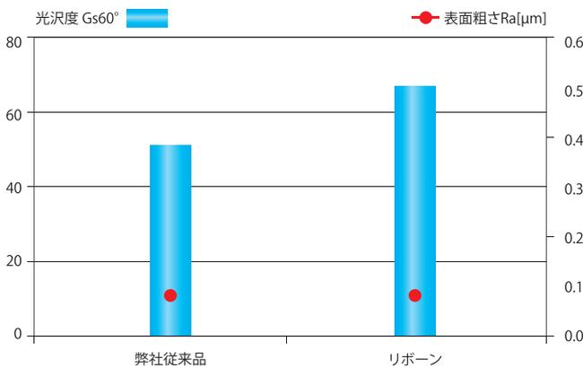
【試験方法】ビューティフィルⅡを #600 の研磨紙で整えた後、下記の条件で研磨
