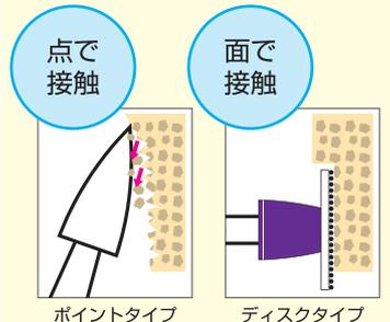
ディスクタイプは面で接触する為、均一かつ容易に研磨することができ、ポイントタイプよりも高い研磨性を発現します。
