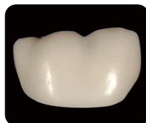
焼結後(表面粗さ: 0.246μm)
