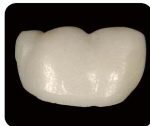
焼結後(表面粗さ: 0.641μm)
