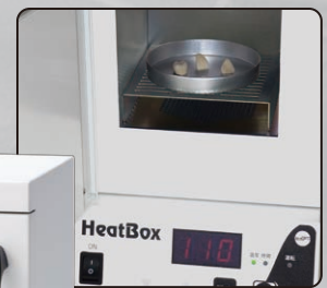
最終光重合後、ヒートボックスで110℃、15分加熱重合を行います。
