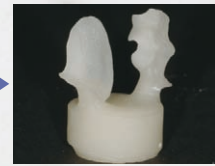
反応層をサンドブラストで除去（フッ酸処理は不要）
