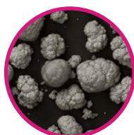
平均粒子径: 54 \mu m SEM画像 (×150)
