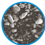
平均粒子径: 65 \mu m SEM画像 (×150)
