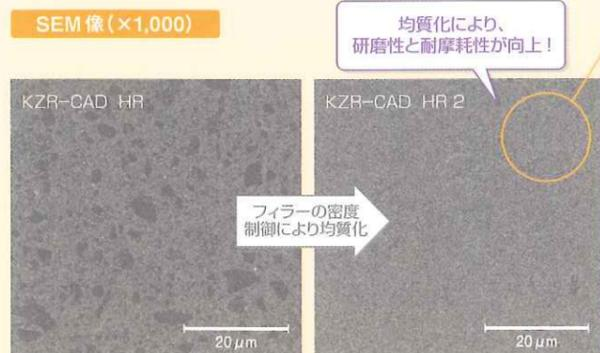
「KZR-CAD HR 2」は、上右図に示すように1~20μmのセラミックス・クラスター・フィラーの粒子密度をマトリックス部とほぼ同じ密度に制御しました。そのため、1,000倍ではフィラーが確認できないほど表面が均質化され、従来品「KZR-CAD HR」の高強度・高耐久性を維持しながら、研磨性と耐摩耗性を飛躍的に向上させることに成功しました。
