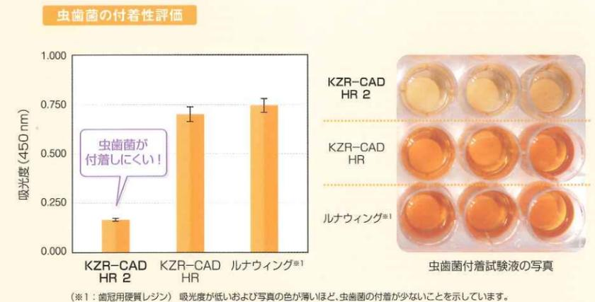
「KZR-CAD HR 2」は、プラークを形成する虫歯の原因菌であるストレプトコッカス・ミュータンス菌が付着しにくい効果を持っています。また、高知大学歯科口腔外科学講座との共同研究で、さまざまな安全性試験に取り組んでおり、口腔内を想定した細胞に対する安全性についても評価しています。(参照: 安全性試験レポート Vol.8 ハイブリッド型硬質レジン「ツイニー」の生物学的評価)
