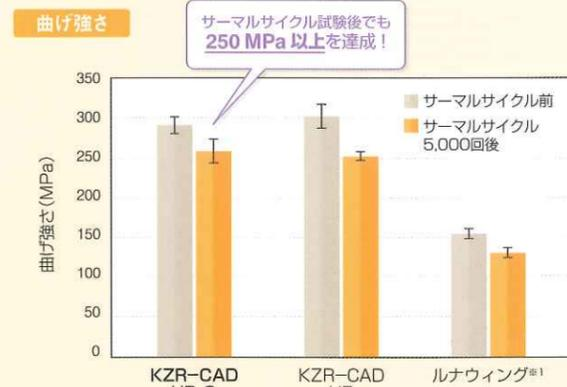
「KZR-CAD HR 2」は、サーマルサイクル試験後(5,000回、4℃-60℃、約1.5年に相当<sup>※2</sup>)においても250 MPa以上の高い曲げ強さを維持し、「KZR-CAD HR」と同等の優れた耐久性を有しています。
