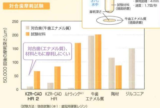
「KZR-CAD HR 2」は、「KZR-CAD HR」と同様に、自身が摩擦しにくいだけでなく、対合歯も傷めにくく、適度な耐摩耗性を持つため、咬合バランスがくずれることによる問題が生じにくいと考えられます。
