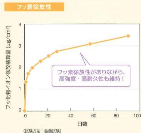
「KZR-CAD HR 2」は、フッ素徐放フィラーの表面処理条件の最適化により、長期的にフッ化物イオンを放出しながらも安定して強度を維持します。
