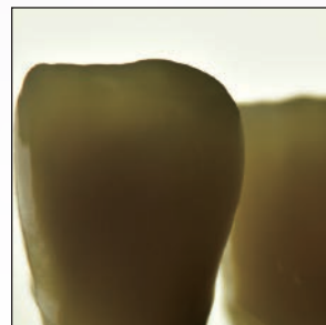
GRブロックを切削加工したものに光を当てた写真。切端部の透明性が高いことが分かる
