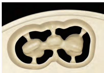
4 KZR-CAD ピークを加工機で切削します。
