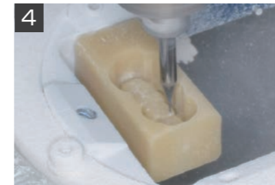
4 切削加工をおこない、カーバイトバー等を用いて切り出し・調整
