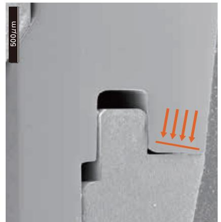
アバットメント辺縁部に1°のテーパを付与することによって、インプラント体とアバットメントは辺縁部に最も強い圧力で接触。さらにアバットメントスクリューでインプラント体とアバットメントを締め付けることにより、ミクロン単位の凹凸を避け、高い封鎖性を実現。(図3)
